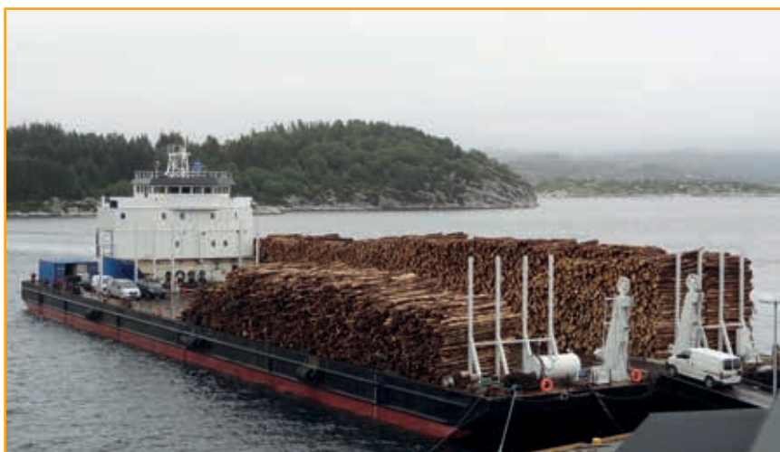
Skogplattforma Frøya US 102 ligger her ved Rubbestadneset i Bømlo kommune. Det nærmer seg opplasta 5000 kubikkmeter tømmer. Lossing til skip vil her skje når plattformen ligger forankra i land og skogsdrift pågår. Foto: Helge Kårstad
