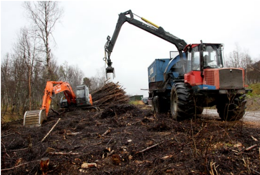
VARIERT UTSTYR: Olsrud bruker av og til gravemaskin og bjørkevirket samles i lunner og flises før det kjøres til mottaker i kontainere.
