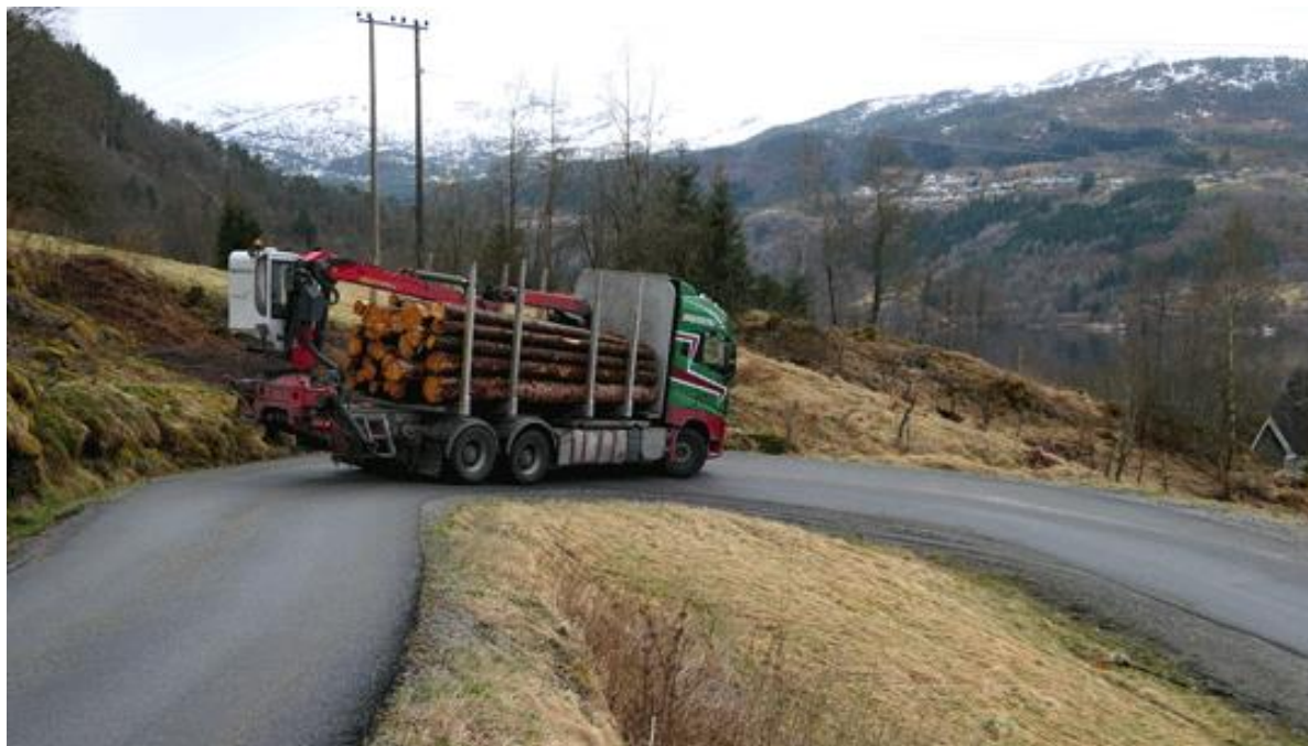
Kipping av tømmer, her ved Erdal i Førde kommune, Sogn og Fjordane. Vegen er kommunal (BK10, 12,4 m) og flaskehalsen er i hovedsak denne krappe svingen med svingradius under 10 meter.
